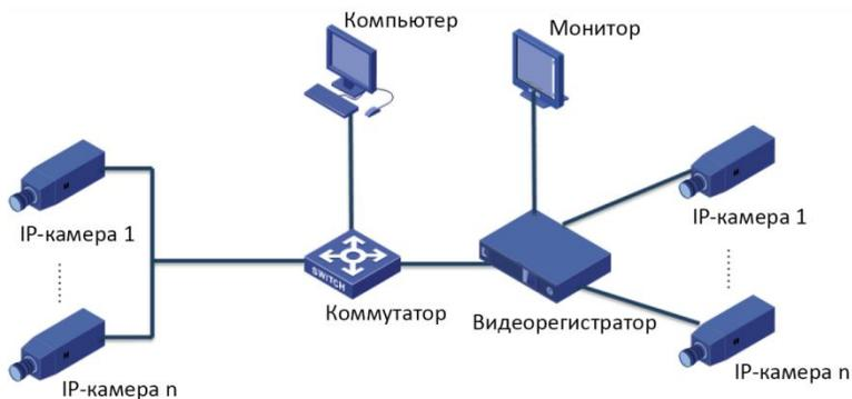
Видеорегистратор, IP-камеры и компьютер подключены к частной сети (или локальной сети). IP-камеры можно подключить к видеорегистратору напрямую или через коммутатор. И вы управляете видеорегистратором и подключенными к нему IP-камерами с помощью монитора или с помощью веб-браузера на компьютере.
