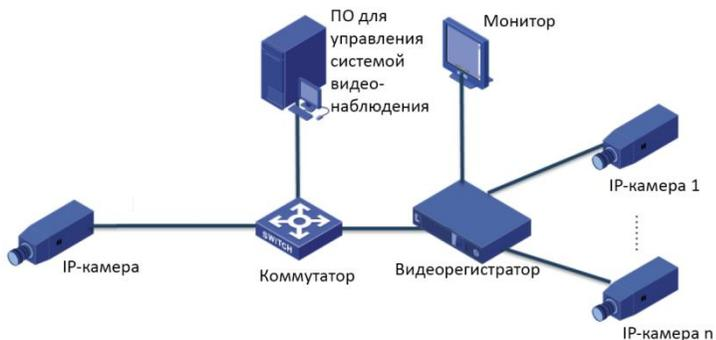
Видеорегистратор, IP-камеры и компьютер подключены к частной сети (или локальной сети). IP-камеры можно подключить к видеорегистратору напрямую или через коммутатор. На компьютер установлено программное обеспечение для управления системой видеонаблюдения. Вы можете управлять видеорегистратором и подключенными к нему IP-камерами, используя программное обеспечение для управления системой видеонаблюдения или с помощью монитора.
