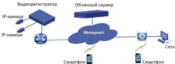
Видеорегистратор и подключенные IP-камеры подключены к частной сети (или к локальной сети), а вы управляете этими устройствами с помощью облачного сервера - облачного решения для управления устройствами с помощью интернета. После регистрации учетной записи в облаке и правильной настройки сетевых устройств (включая маршрутизатор), вы можете управлять видеорегистратором и подключенными к нему IP-камерами с компьютера или мобильного телефона.
