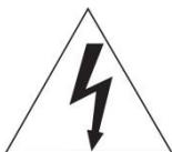
Молния со стрелкой в равностороннем треугольнике предупреждает пользователя о наличии опасного напряжения внутри корпуса изделия, которое может привести к поражению электрическим током.
