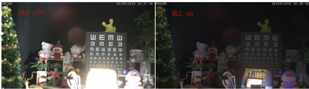
Рисунок 4-3-7 Компенсация бликов света
