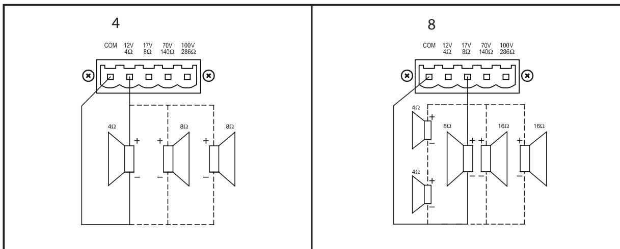
**Схема подключения трансляционных линий 70 и 100 В.**
