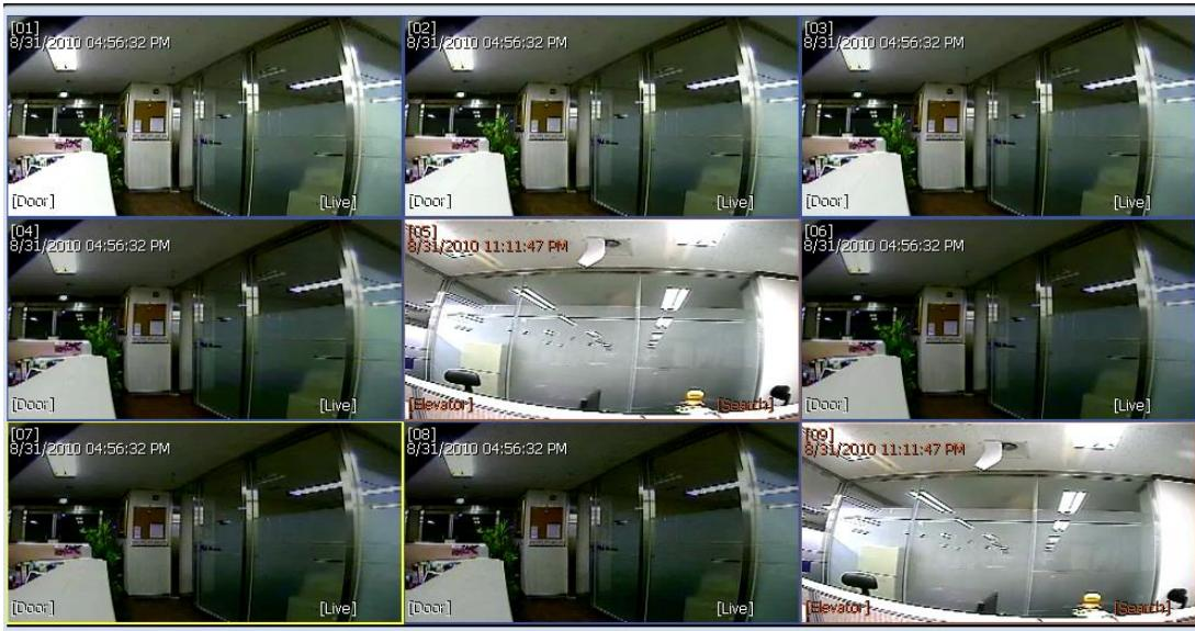
В режиме отображения в реальном времени текст LIVE (Реальное время) отображается белым, а канал имеет синюю окантовку.
