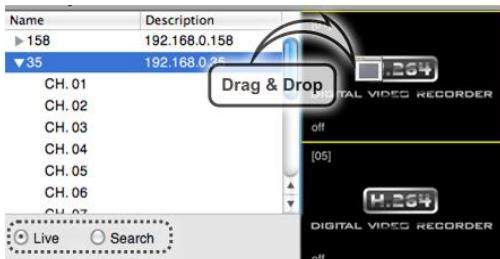
На панели Site List (Перечень DVR) отображается перечень зарегистрированных DVR Для подключения перетащите DVR
