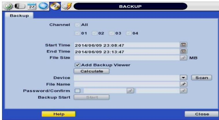
**ПРИМЕЧАНИЕ** Устройство резервного копирования должно быть производства известного крупного изготовителя. Накопители USB должны быть в формате FAT/FAT32 для правильного выполнения резервного копирования.
