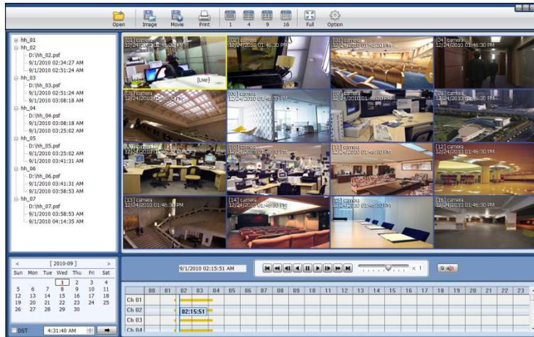
Пользователь может распечатывать, захватывать кадры, уменьшать зум или конвертировать файл в формат ASF при помощи иконок в верхней части окна плейера.
