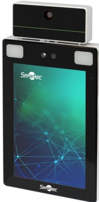
Биометрический считыватель ST-FR043T предназначен для идентификации по геометрии лица и используется в системах контроля доступа и учета рабочего времени. Устройство поддерживает следующие режимы идентификации: по геометрии лица, по ладони, по коду. Считыватель предназначен для использования в помещении в диапазоне температур от +16°C до +35°C.
