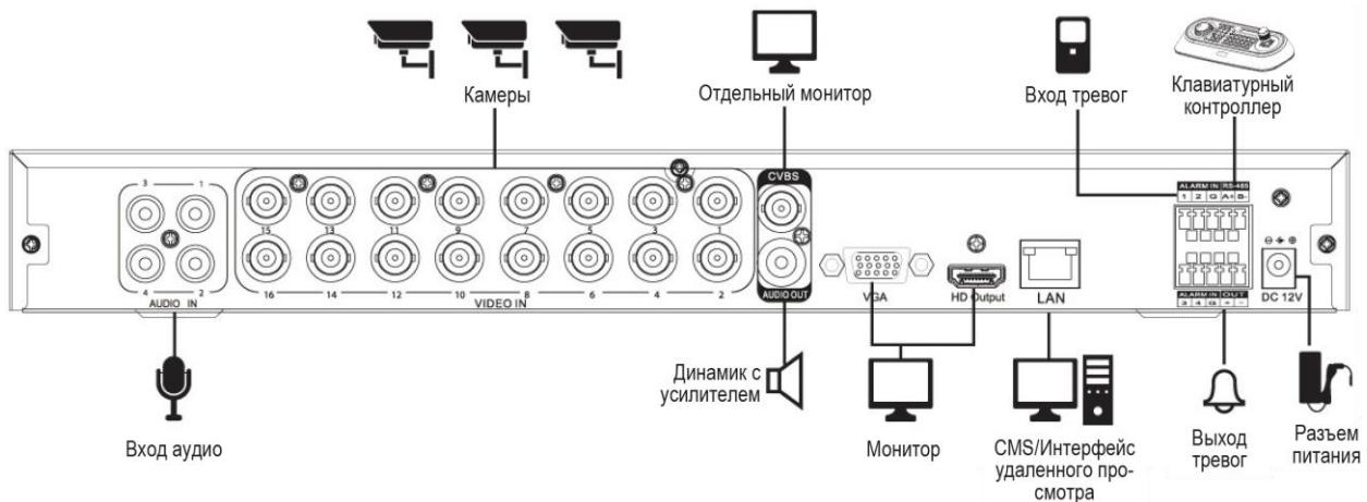
Рис. 2-1 Порядок подключения
