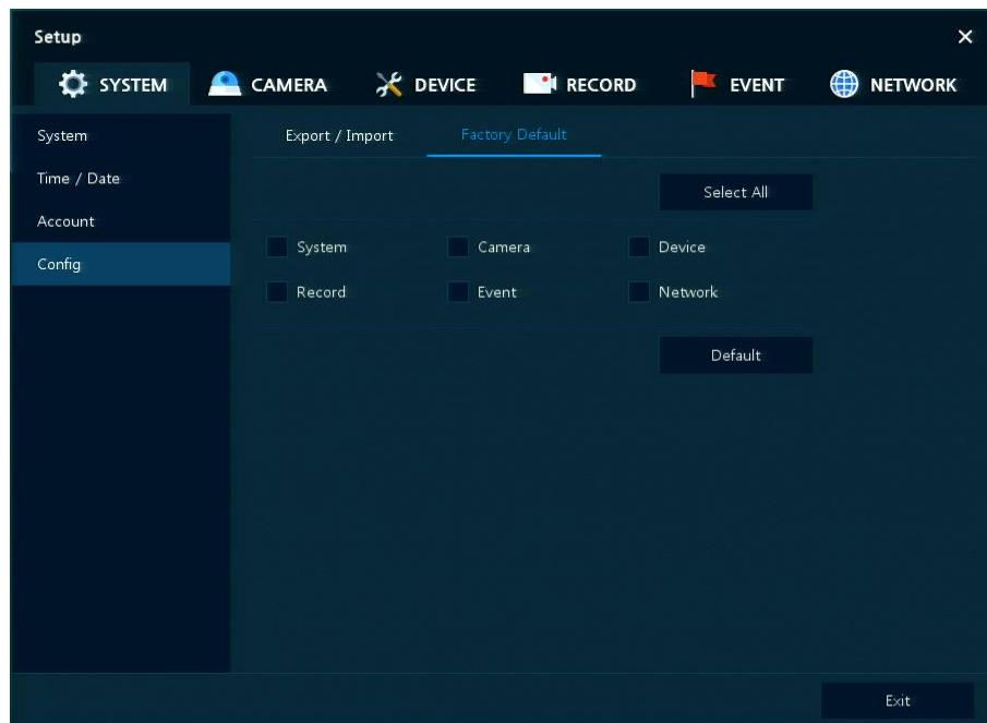
Рис. 4-13 СИСТЕМА > Конфигурация > Сброс на заводские настройки
