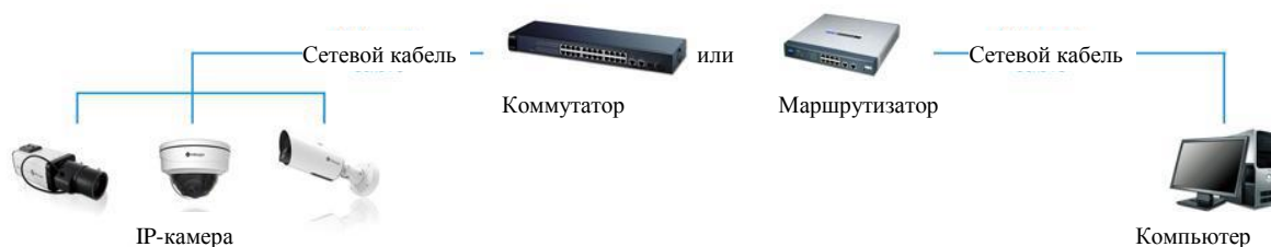
Рисунок 2-1-2 Подключение через коммутатор или маршрутизатор
