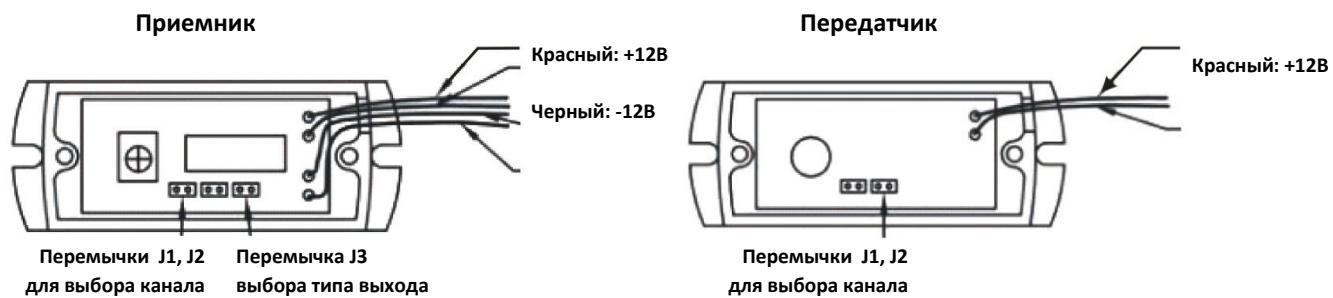
Перемычки J1 и J2 используются для установки одного из 4-х каналов, данные перемычки должны быть установлены одинаково для приемника и передатчика. Перемычка J3 используется для установки типа выхода. Установите данную перемычку, если требуется Н3 выход, а если требуется НР, уберите перемычку.
