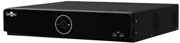
Виртуальная матрица STNR-6462 представляет собой универсальное системное решение для создания УРМ без использования управляющего программного обеспечения на выделенной рабочей станции (ПК). Обеспечивается отображение и дублирующая запись до 64 камер, подключенных к видеорегистраторам Delta-серии.
