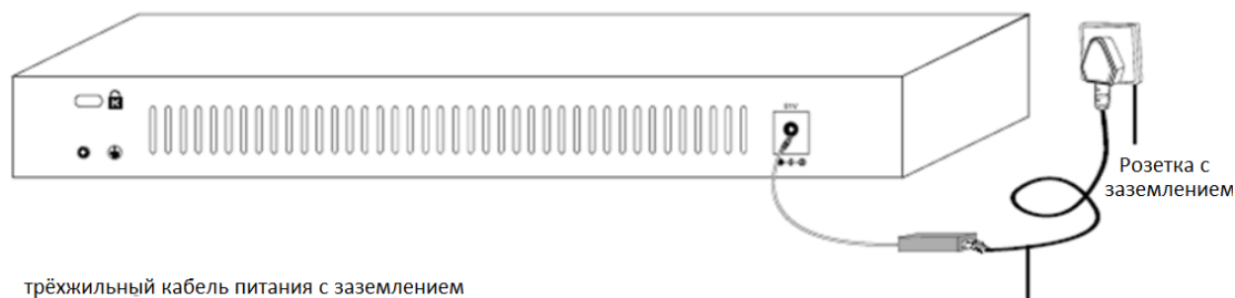
Рисунок 2.7 Заземление с использованием трехжильного кабеля питания
