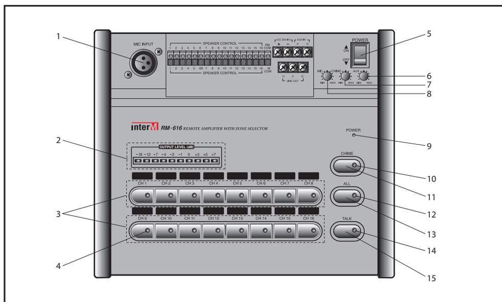
**1. Разъем подключения держателя микрофона**
