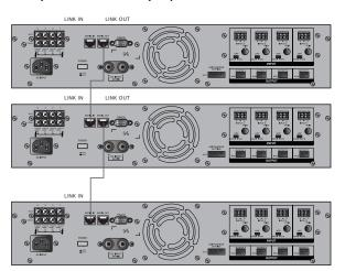
Каждому блоку DPA-5075М при помощи переключателей, расположенных на задней панели, необходимо присвоить индивидуальный сетевой адрес. Восемь переключателей соответствуют восьми разрядам двоичного числа. При верхнем положении переключателя значение разряда равно 1, при нижнем положении переключателя значение разряда равно 0.
