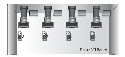
2) Диапазон значений ослабления входного сигнала: 0 дБ — бесконечность Перемычки CN351, CN352, CN353, CN354 должны замыкать контакты 1 и 2.
